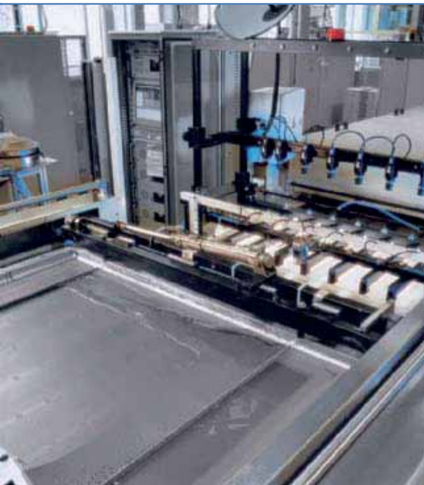
Impresora serigráfica para la aplicación de la tinta que cambia de color a los billetes de 50€.
