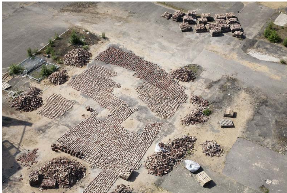
Abbildung 58 Zum Trocknen ausgelegte Klinker
